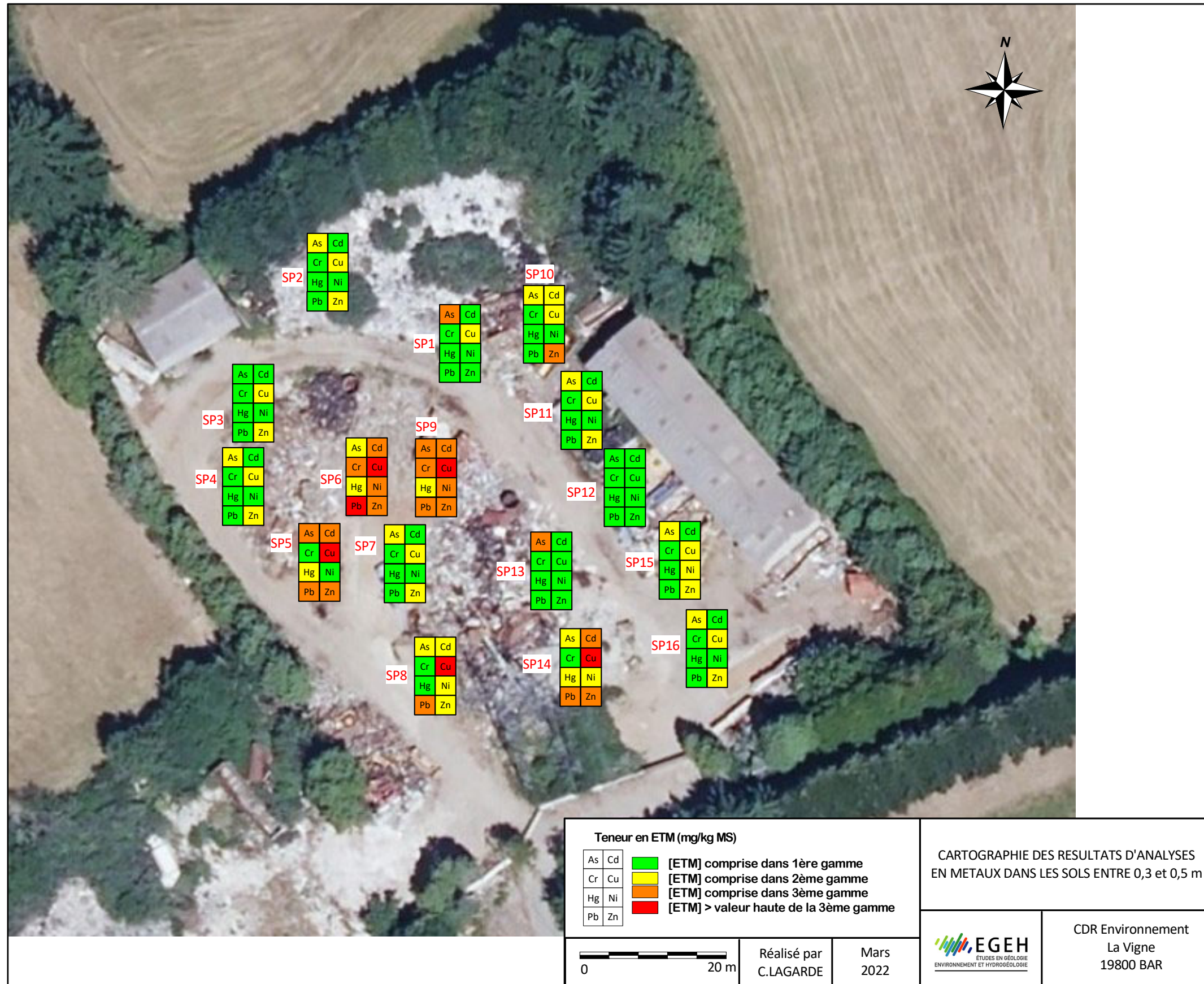
Figure 3 – Cartographie des résultats d'analyses en métaux dans les sols entre 0,3 et 0,5 m
